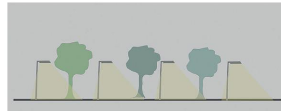
Abbildung 5.5 Kombinierte Wirkung von abgeschirmten Leuchten und kurzen Masten zur Begrenzung der störenden Lichtausbreitung in angrenzende Räume (Engl.: „light trespass“). Erstes Bild – nicht abgeschirmte Leuchten, zweites Bild – abgeschirmte Leuchten. Das dritte Bild zeigt abgeschirmte Leuchten auf kurzen Masten, die die ungewollte Lichtausbreitung verhindern und somit benachbarte Bereiche dunkel halten (© H. LIMPENS).
